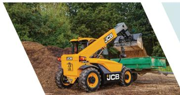
4 m - 10 m Arbeitshöhe; Egal ob starrer oder drehbarer Oberwagen, die Teleskopstapler mit den verschiedenen Anbaugeräten sind vielseitig einsetzbar. Außerdem lassen sich durch den teleskopierbaren Mast verschiedene Arbeiten in unterschiedlicher Reichweite verrichten.
