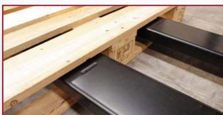
Gabelmarkierung für optimale Positionierung bei seitlichen Anheben einer Europalette
