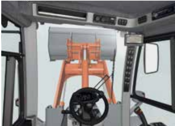
Vorne: Bodentief freie Sicht ohne störende Lenksäule.
