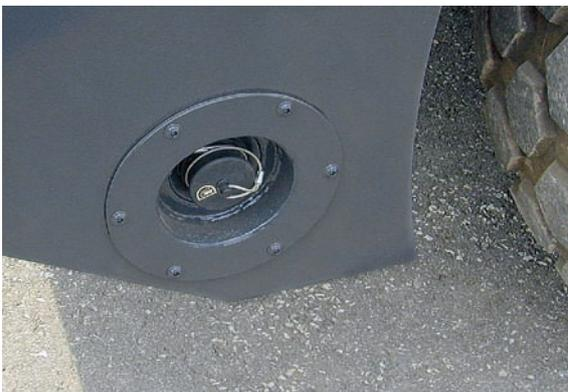
Druckbetankungsanlage für schnelles Betanken.
