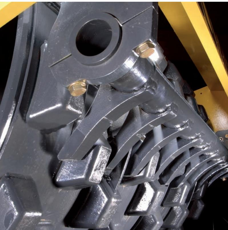
Die Glattbandagen lassen sich mit einem Segmentmantel einfach in Stampffußbandagen umrüsten. So wird das Einsatzspektrum enorm erweitert. Die dreiteilige Form garantiert optimale Anpassung und leichte Montage. Auch hier sorgen die Abstreiferbalken für minimale Umrüstzeiten: Bei herkömmlichen Konzepten müssen über 50 Schrauben gelöst und wieder angezogen werden. Bei BOMAG sind es nur zwölf, die zudem hervorragend zugänglich sind.
