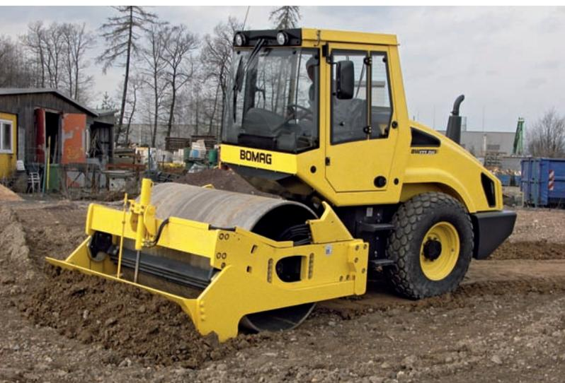
Verteilen und Verdichten gleichzeitig: Walzenzug mit Schubschild, hier eine BW 177 DH-4.
