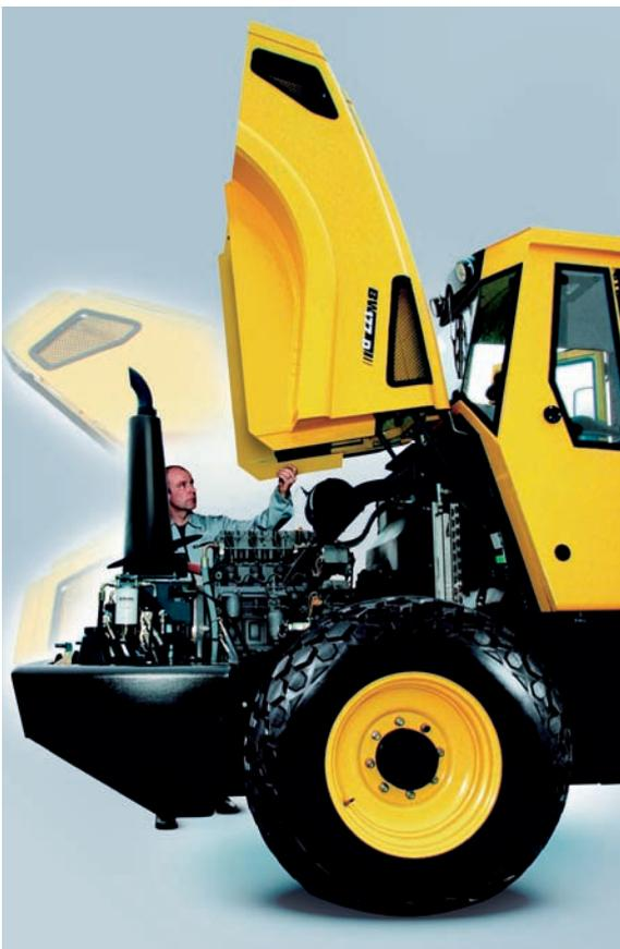
Sichere Sache: Die wenigen Wartungspunkte sind vom Boden zu erreichen. Die Haube lässt sich leicht von Hand öffnen.
