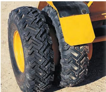
**Die optionale Doppelbereifung** verbessert die Tragfähigkeit auf weichen Böden und ermöglicht Arbeiten bei schwierigen Bodenverhältnissen.
