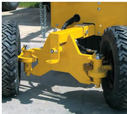
**Die optionale hydraulische Vorderlenkung** mit oszillierender Achse sorgt für mehr Beweglichkeit und leichtere Steuerung. Die Stifte und Buchsen der Achse sind stahlgehärtet.
