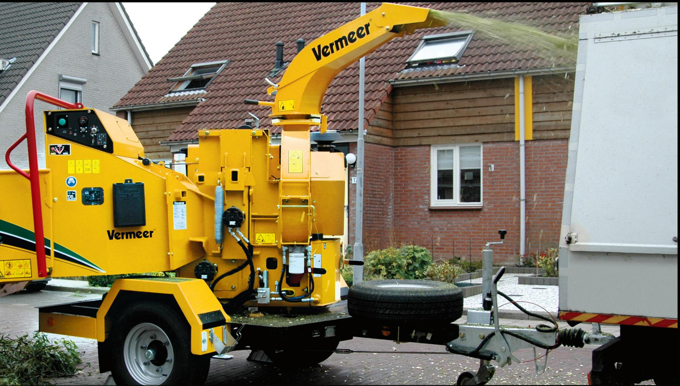
**5: Hohe Bodenfreiheit.** Mit einer Bodenfreiheit von 36 cm unter dem Chassis und 26 cm unter der Achse kann der Häcksler problemlos in schwierigem Gelände betrieben werden.
