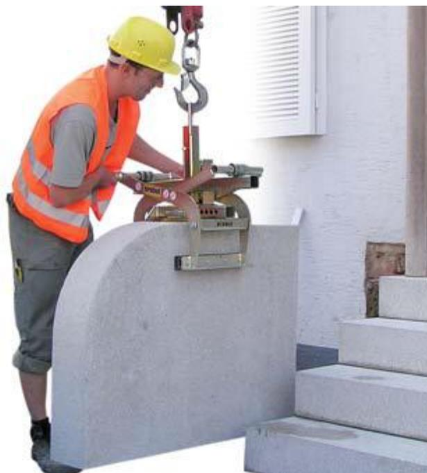
Geeignet zum Greifen und Versetzen von Trittstufen, Bordsteinen, Rankwinkeln, L-Steinen und dergleichen mit einem Hebezeug
