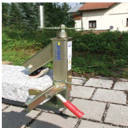
Stele/Palisade wird liegend eingespannt und gegriffen
