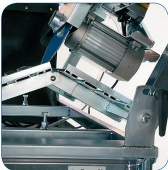
Stufenlose von 0 - 45 Grad verstellbare und leichtgängige Kipptechnik für höchste Präzision
