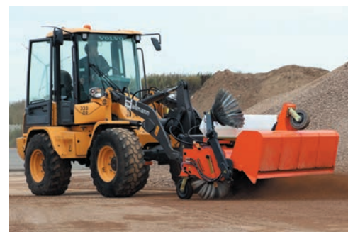
bema 35 Dual PowerMaster mit Wassersprüheinrichtung und Seitenkehrbesen (Freikehren)
