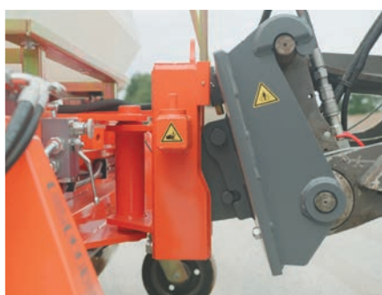
3D-Ausgleich und optionales Drehgelenk
