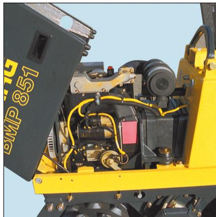
Hohe Kraftreserven, selbst unter extremen Bedingungen, bietet der drehmomentstarke 2-Zylinder Hatz Dieselmotor mit Ölmangelabschaltautomatik.
