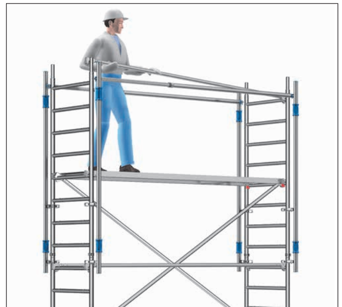
Bild 6: Sichere Montage der Rückenlehnen mit MSG
