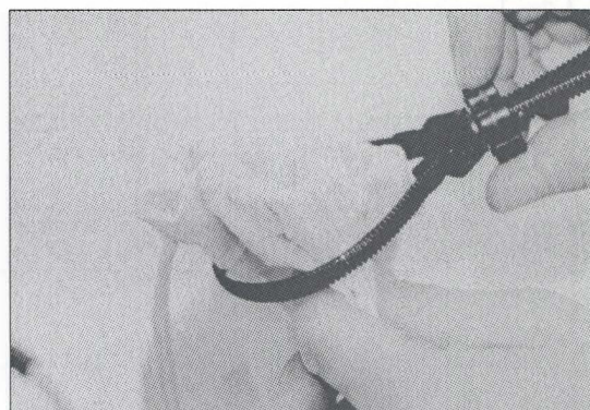
Abb. 3 MultiClip über den Staubsack schieben und...
