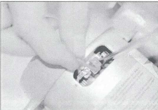
Abb. 31 ...Sie den Spannbügel nach rechts klappen und die Kohlenbürste entnehmen.
