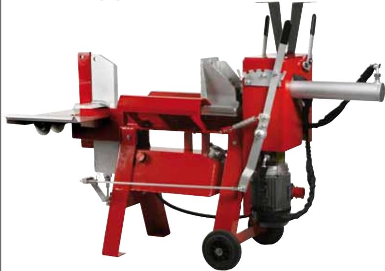
**D**er HEL09 ist der kleine Letzte aus der VOGESENBLITZ Horizontal Serie. Mit 9 Tonnen Spaltkraft und verstellbares Messer ab Bedienungsstand, bietet diesen Spalter eine unvergleichbare Bedienungsbequemlichkeit. Dazu sichert den angebauten 4 KW Motor die nötige Kraft bis zu 550 mm Spaltlänge.
