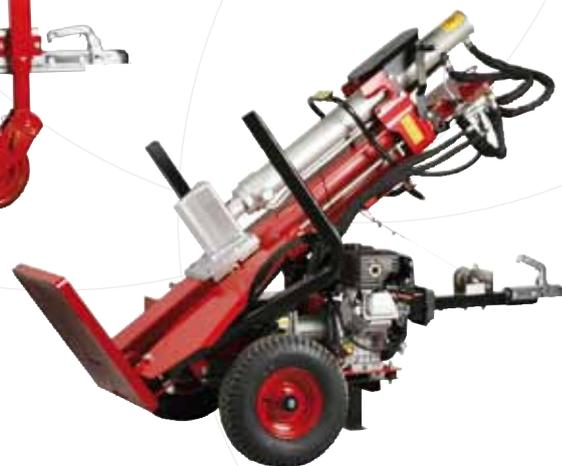
VMR-S auf Traktorfahrwerk, mittels Seilzug schwenkbar
