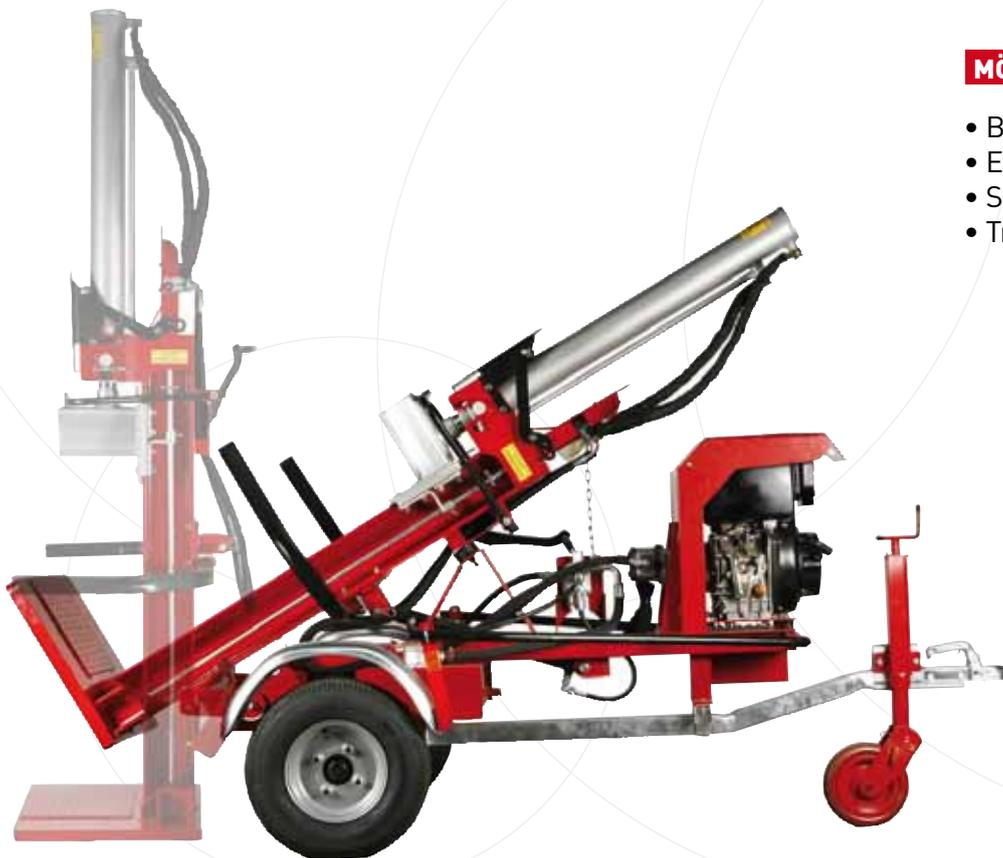
Strassenfahrwerk und hydraulische Schwenkvorrichtung
