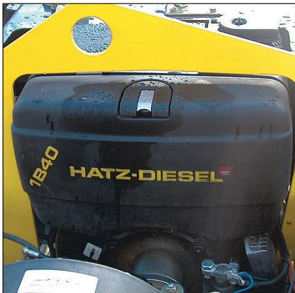
Um den erhöhten Leistungsbedarf für den Betrieb mit Hydraulikhammer abzudecken, ist die Maschine mit dem Hatz-Dieselmotor 1 B 40 ausgestattet.
