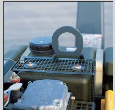
Die zentrale Aufhängöse und die seitlichen Befestigungsösen gewährleisten einen schnellen und sicheren Transport.
