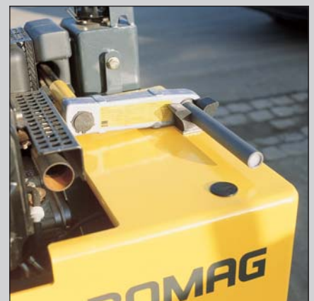
Die Sicherheitskurbel ist immer direkt verfügbar.
