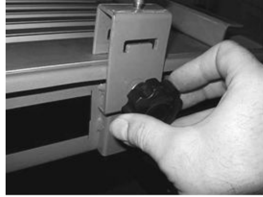
Die 2 Halter der Längsschnittführung auf die Bolzen setzen und mit der Rändelschraube sichern
