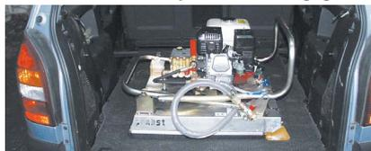
Mit dieser Transporthalterung wird der Handgriff zum Tragegriff.
