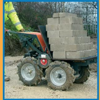
Flachbett für Betonblöcke und Zementsäcke
