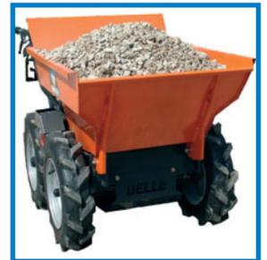
Grosse Hochleistungs-Kippvorrichtung trägt faltbare und einfach zu befördernde Rampe von bis zu 300 kg.
