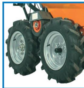
Trägersrad wird entkoppelt für einfachen Radwechsel.
