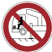
⇒ Im ausgehobenen Zustand muss das Fahrerhaus leer sein und lastfrei bleiben. D. h. bei ausgehobener Vorderachse ist der Aufenthalt im Fahrerhaus verboten! Zuladungen im Fahrerhaus bzw. zusätzliche Lasten oder Anbauten am Fahrerhaus sind ebenfalls verboten! Vorderauftritte dürfen nicht benutzt werden!
