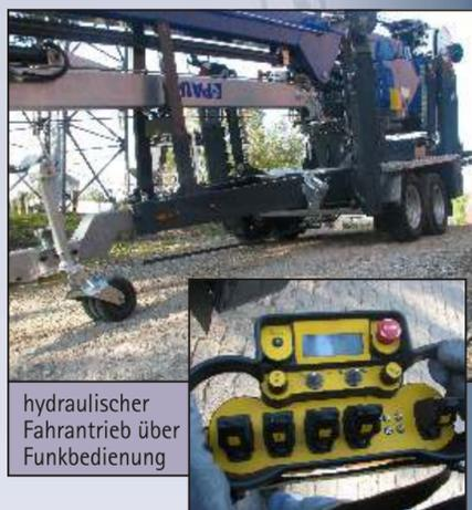
hydraulischer Fahrtrieb über Funkbedienung
