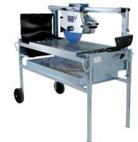
**STEINTRENNSÄGE S-120 GERADE** Mit einer Schnittlänge von 1.250 mm entspricht sie 100% den Anforderungen an neue und grossdimensionierte Materialien. Die präzise Support-Führung garantiert ein perfektes Schnittergebnis. Diese Maschine vereint Robustheit und absolute Präzision. Leistung 2.200 W/230 V; Schnittlänge 1.250 mm; Schnitttiefe max. 110 mm; Gw. 125 kg; Sonderpreis inkl. Diascheibe 350 mm
