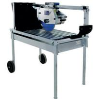
**STEINTRENNSÄGE S-90 K** (wie S-83 G) zusätzlich; stufenlos verstellbare Gehrungsschnitte von 0-45 Grad; Leistung 2.200 W/220 V; Schnittlänge 900 mm; Schnitttiefe max. 110 mm; Gw. 90 kg. Sonderpreis inkl. Diascheibe 350 mm
